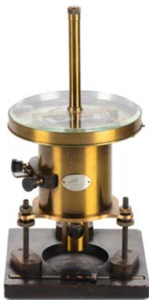
82 GALVANOMETRO A SOSPENSIONE, INGHILTERRA SECONDA METÀ XIX SECOLO Firmato, su piastra in argento: "Lord Kelvin's patent - multicellular voltmeter n. 938 James White - Glasgow"; involucro in ottone dorato, con indice a sospensione, a lettura orizzontale su scala (logaritmica) da 0 a 500, estesa a quarto di cerchio su angolo di circa 50°. € 700 - 800
