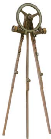
85 CERCHIO GONIOMETRICO "RAPPORTATORE" DETTO ANCHE "STATION POWER", INGHILTERRA, 1923 era utilizzato in genere in marina e, questo in particolare, in dotazione alla Marina Militare Inglese. Firmato: "Stanley GT - Turnstle - London 1923" Goniometro a cerchio intero con divisioni 0 - 180 - 180 - 0, cm 12,5x58x13,8 € 350 - 400
