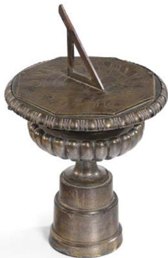
75 MERIDIANA DA GIARDINO IN BRONZO FUSO A FORMA OTTAGONALE CON GNOMONE A PENDEN- ZA DI 51° (LONDRA). RARO OGGETTO DELL'IM- PORTANTE PRODUZIONE INGLESE DELLA FINE DEL 1700 - PRIMI 1800. tracciato orario da IIII a XII a VIII, inciso a bulino con belle forme dei numeri romani, tra i quali la scala è indicata con tracciato di 5 minuti in 5 minuti con elevazione dell'indicazione delle mezze ore. Diametro max - 24 cm; Altezza 38,5 cm € 1.000 - 1.200
